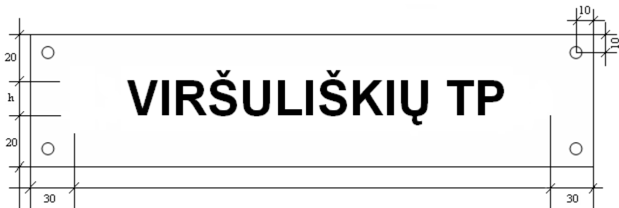
1 pav. 35-110 kV transformatorių pastočių pavadinimo plokštelė
