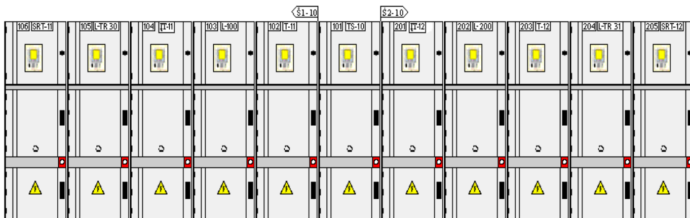
5 pav. 10 kV šynų sekcijų ir narvelių žymenys
