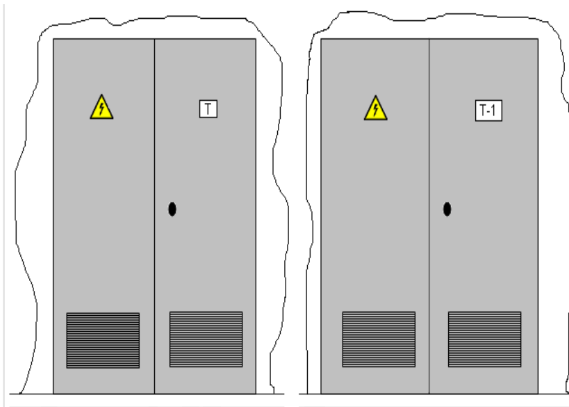
6 pav. Transformatoriaus patalpos durų žymenys
