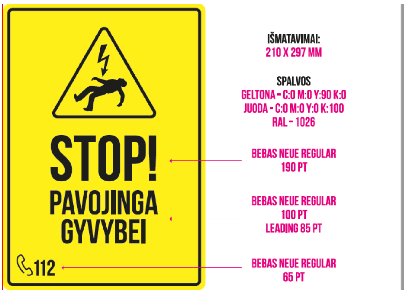
14 a pav. papildomi žymenis įrengiami ant „Šiaulių“ tipo komplektinės transformatorinės
