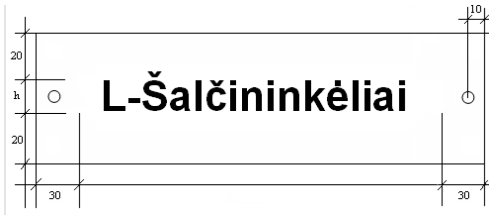
3 pav. Narvelio pavadinimo plokštelė
