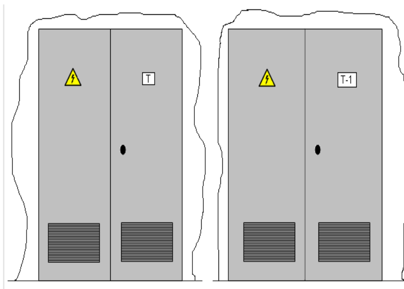
6 pav. Transformatoriaus patalpos durų žymenys
