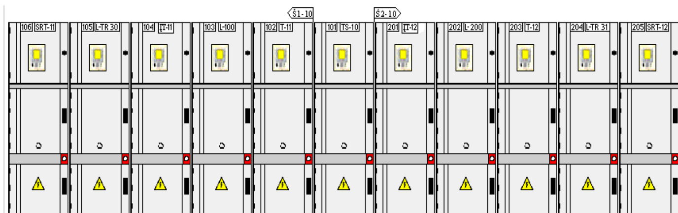
5 pav. 10 kV šynų sekcijų ir narvelių žymenys
